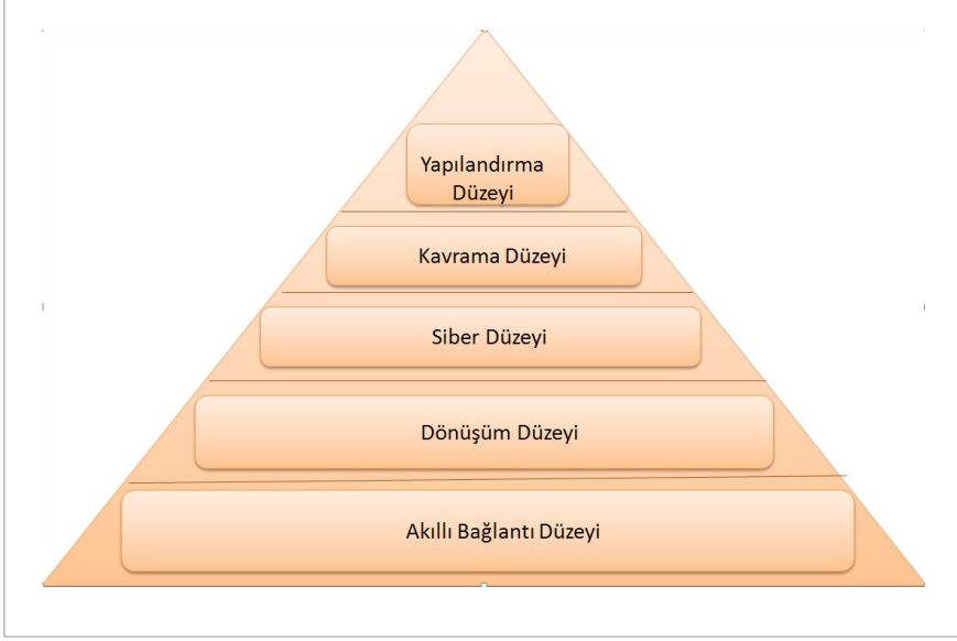
ŞEKİL 5: SİBER FİZİKSEL SİSTEM KURULUMUNDA 5C MİMARİSİ
